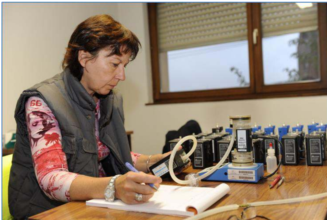
Photographie 2 : opération de contrôle de débit du dispositif de prélèvement avant et après prélèvement.
